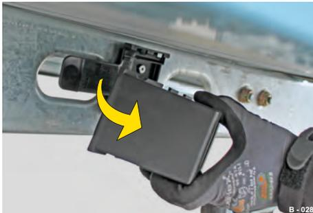
**Abb. 167** Unterlegkeil entnehmen
