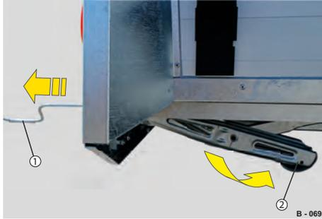
**Abb. 196** Hochstellen, Fahrstellung
