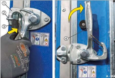
**Abb. 217** Winkelhebelverschluss geschlossen / geöffnet
