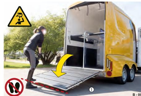
Abb. 137 Heckklappe abklappen
