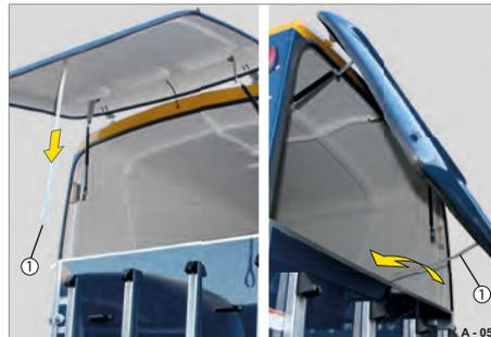
**Abb. 268** GFK-Heckklappe herunterziehen / Bediengurt verstauen
