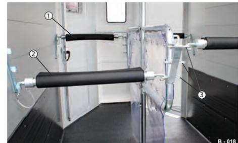
Abb. 154 Brust- / Heckstangen
