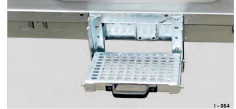
Abb. 119 Trittstufe, Sattelkammerkabine
