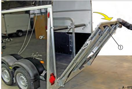
**Abb. 288** Heckklappe abklappen
