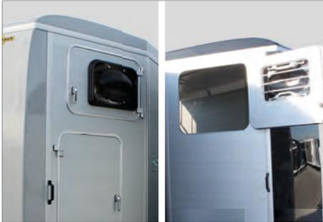
Abb. 313 Lüftungsfenster geschlossen / geöffnet
