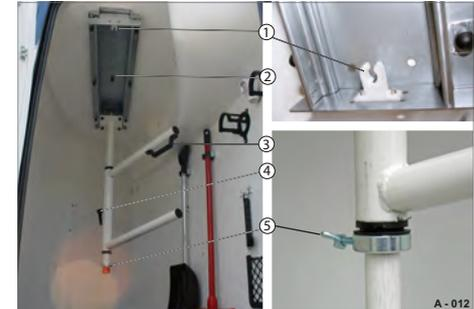
Abb. 227 Sattelhalter ausziehbar / schwenkbar
