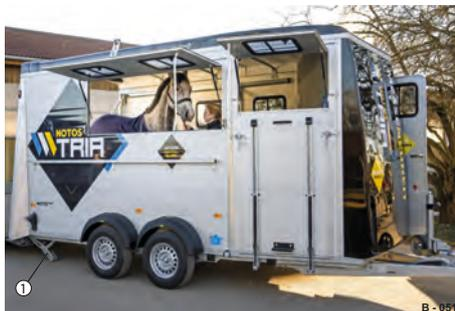
**Abb. 175** Anhänger heckseitig abgestützt
