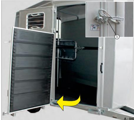
**Abb. 255** Drehtür aufschwenken
