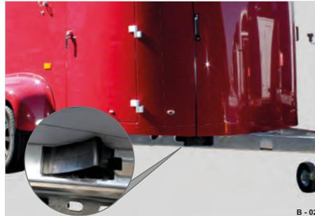
**Abb. 164** Beispiel: Position, Unterlegkeile
