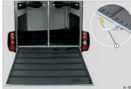
**Abb. 289** Heckklappe abgeklappt
