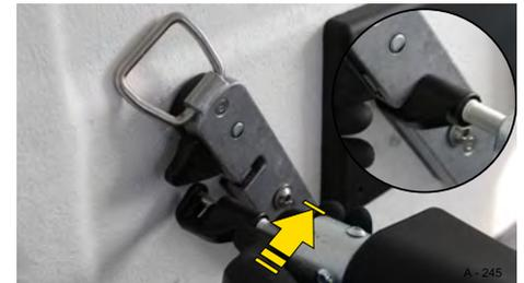
**Abb. 336** Bruststange (Heckstange) einfädeln
