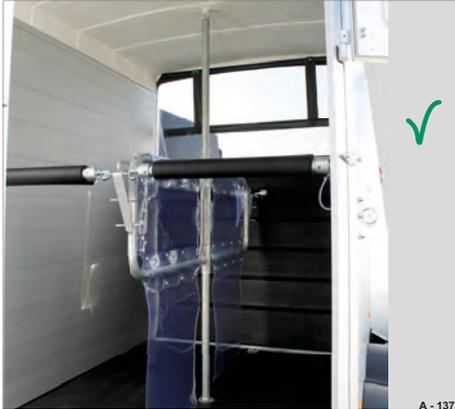
**Abb. 356** Mitteltrennwand, drehbar gesichert
