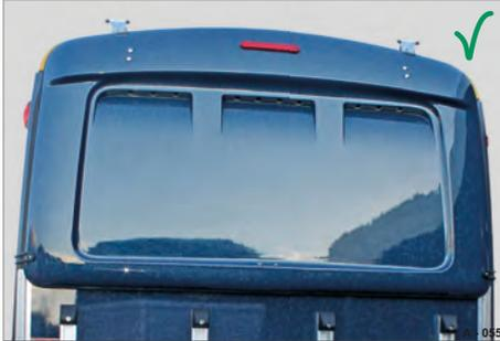
**Abb. 270** GFK-Heckklappe geschlossen und gesichert
