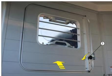
**Abb. 316** Lüftungsfenster von Innen öffnen
