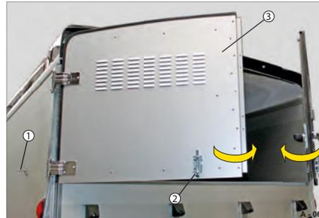
**Abb. 283** Drehklappen schließen
