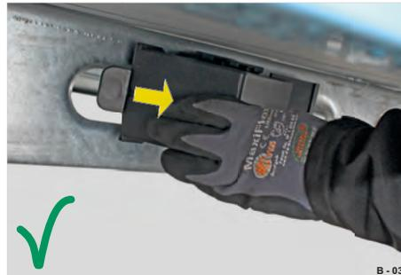
**Abb. 169** Unterlegkeil sichern, Fahrstellung
