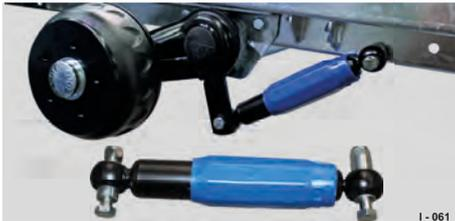
Abb. 116 RSD lose oder eingebaut
