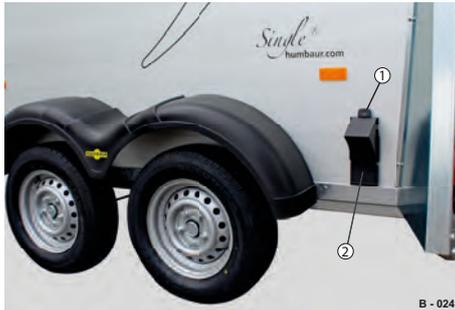
**Abb. 163** Beispiel: Position, Unterlegkeile
