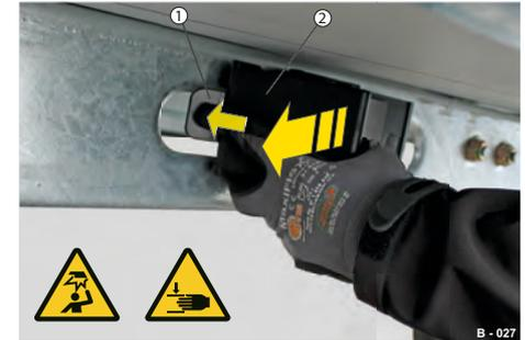
**Abb. 166** Unterlegkeil entsichern
