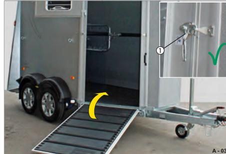
**Abb. 253** Frontausstieg zuklappen
