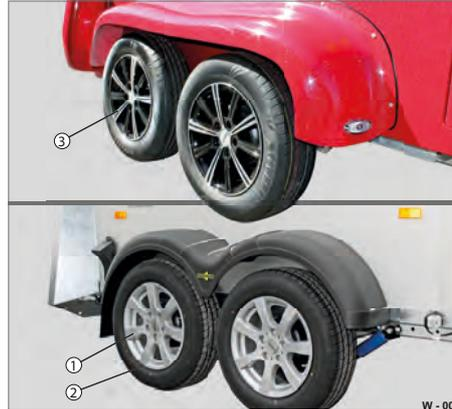
**Abb. 373** Räder / Reifen kontrollieren
