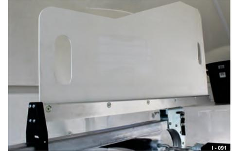
**Abb. 23** Kopftrennwand, verschiebbar
