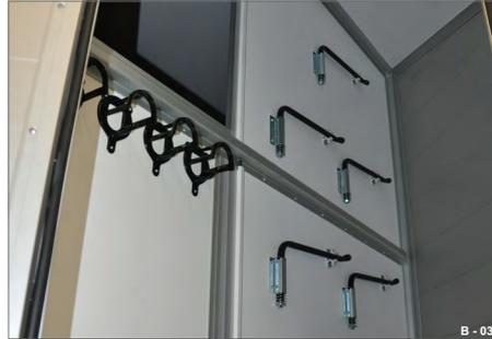
**Abb. 222** Ablagebügel innen, schwenkbar
