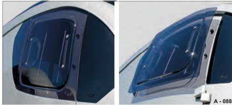
Abb. 303 Geschlossen / parallel geöffnet
