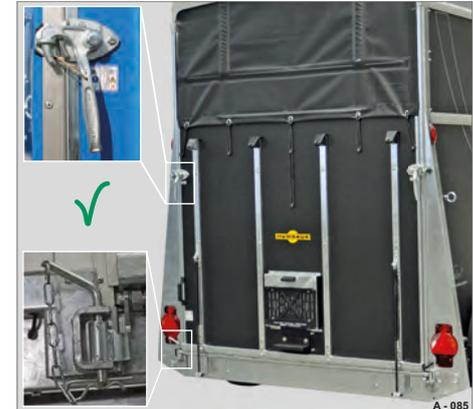
Abb. 300 Drehtür geschlossen und gesichert
