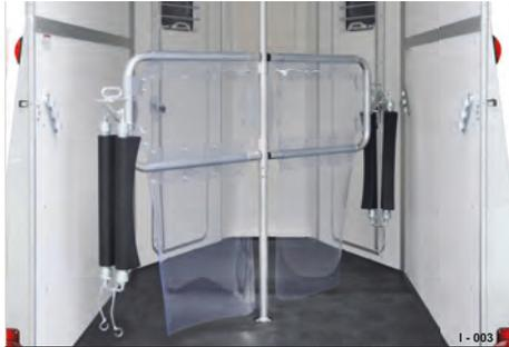
**Abb. 21** Mittelfostentrennwand, schwenkbar (Beispiel Notos)
