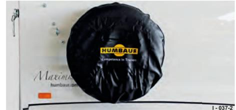
**Abb. 90** Seitlich montiert für 13" und 14" Radgröße
