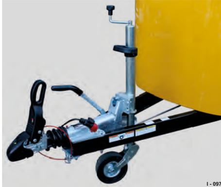
Abb. 35 Antischlingerkupplung, ASK
