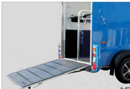
**Abb. 286** Heckklappe, abgeklappt
