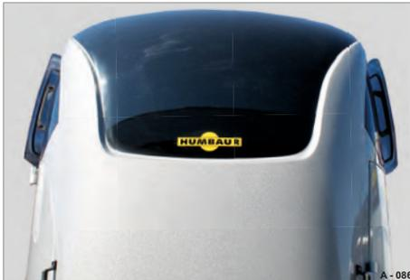
Abb. 301 Ausstellfenster beidseitig geöffnet
