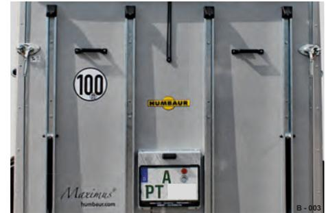
Abb. 135 Max. Geschwindigkeit / 100 km/h Aufkleber
