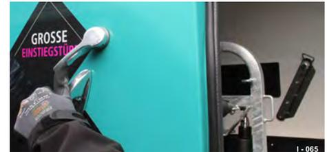
Abb. 120 Schnelllöseverriegelung der Stangen
