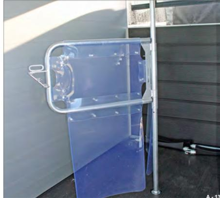
Abb. 351 Gedrehte Stellung der Mitteltrennwand, Notos
