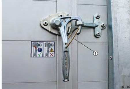
**Abb. 1** Winkelhebelverschluss, gesichert
