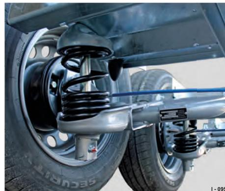
**Abb. 34** EquiDrive PLUS S - Schraubenfederfahrwerk
