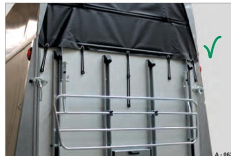
Abb. 278 Fohlgitter abgeklappt und gesichert
