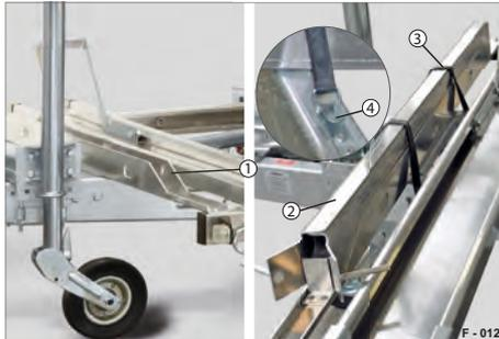
Abb. 211 Auffahrschienen sichern, Variante 1
