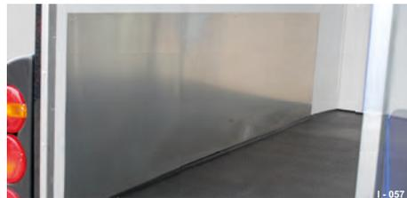
**Abb. 112** Alublech**Trittschutz, Sattelkammer**
