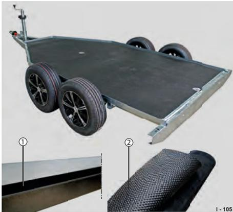
**Abb. 24** AluBiComb-Boden Aufbau
