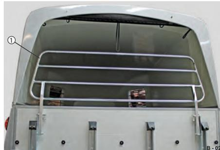
**Abb. 157** Sicherung gegen Herausspringen
