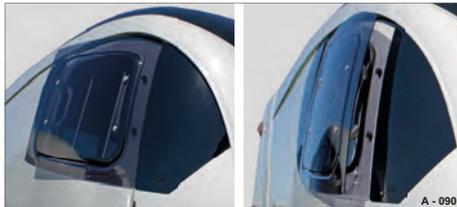
Abb. 305 Nach hinten geöffnet / nach vorn geöffnet
