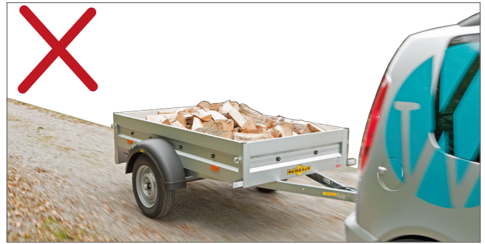
Loses Ladegut nicht gesichert
