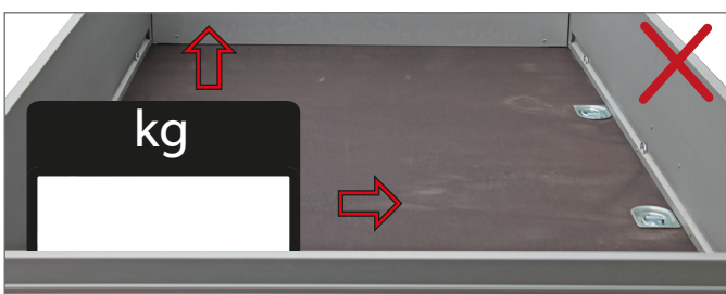
Ladung falsch verteilt
