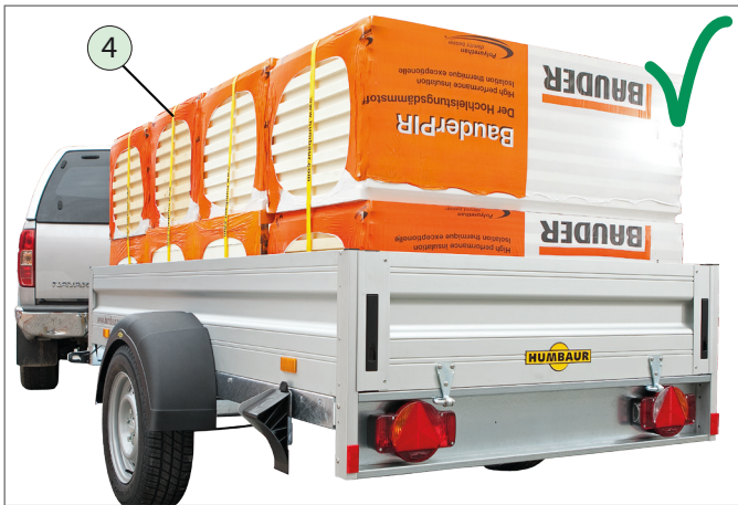
Durch Formschluss und Niederzurrung gesichert
